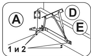
Подъемный механизм крепится к царге (D) винтом №1, к спинке (E) винтом №2 (газлифт крепится к подъемному механизму цилиндром вверх как на схеме)
